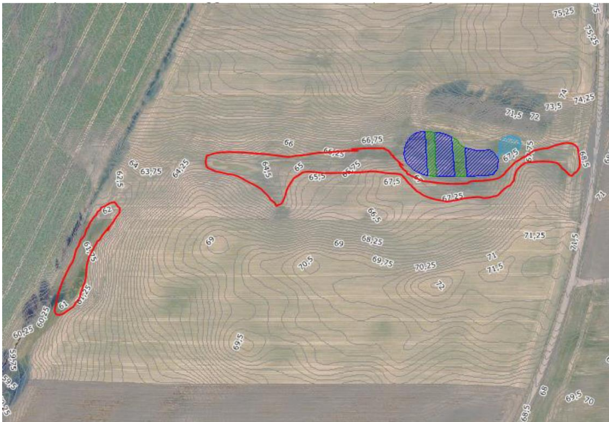
Kortbilag 3: Overskudsjorden placeres inden for de røde linje. Før udlægning afgraves muldjorden delvist (ca. 15 cm). Jorden lægges herefter ud i max 0,5 m. højde
